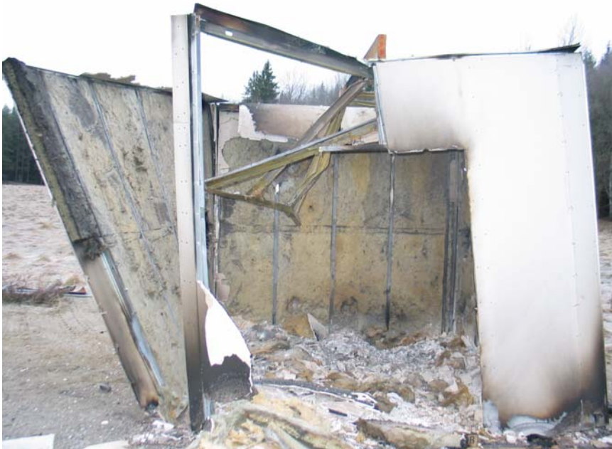
Figur 4. Rum med EI 30-klassade väggar efter brandförsöket.
