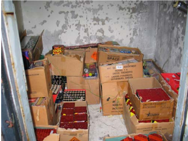
Figur 2. Fyrverkeriernas placering i kassunen före försöket.
