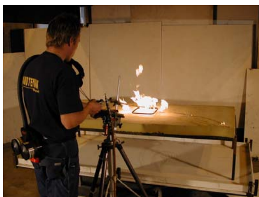
Figur 1. När kravet på yt-skikten är Euroclass B, t.ex. gipsskiva, kan man matcha den säkerhetsnivån med en sjukhusmadrass som tål en tändkälla som på bilden utan att ta eld. Provmetoden heter SS 876 00 10 och krävs numera av flera landsting för högriskområden, t.ex. slutna vårdanläggningar.
