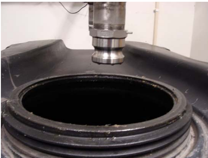
Bild 10 Fyllning utan tapprör (splashfyllning)
