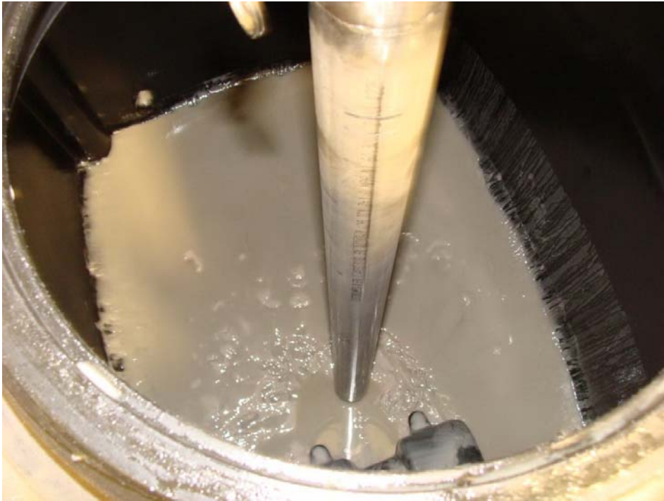
Bild 7 Fyllning med tappprör som går ända ner till botten av kärlet.
