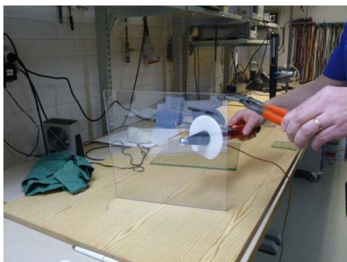
Bild 29 Registrering av urladdning med nanocoloumbmeter
