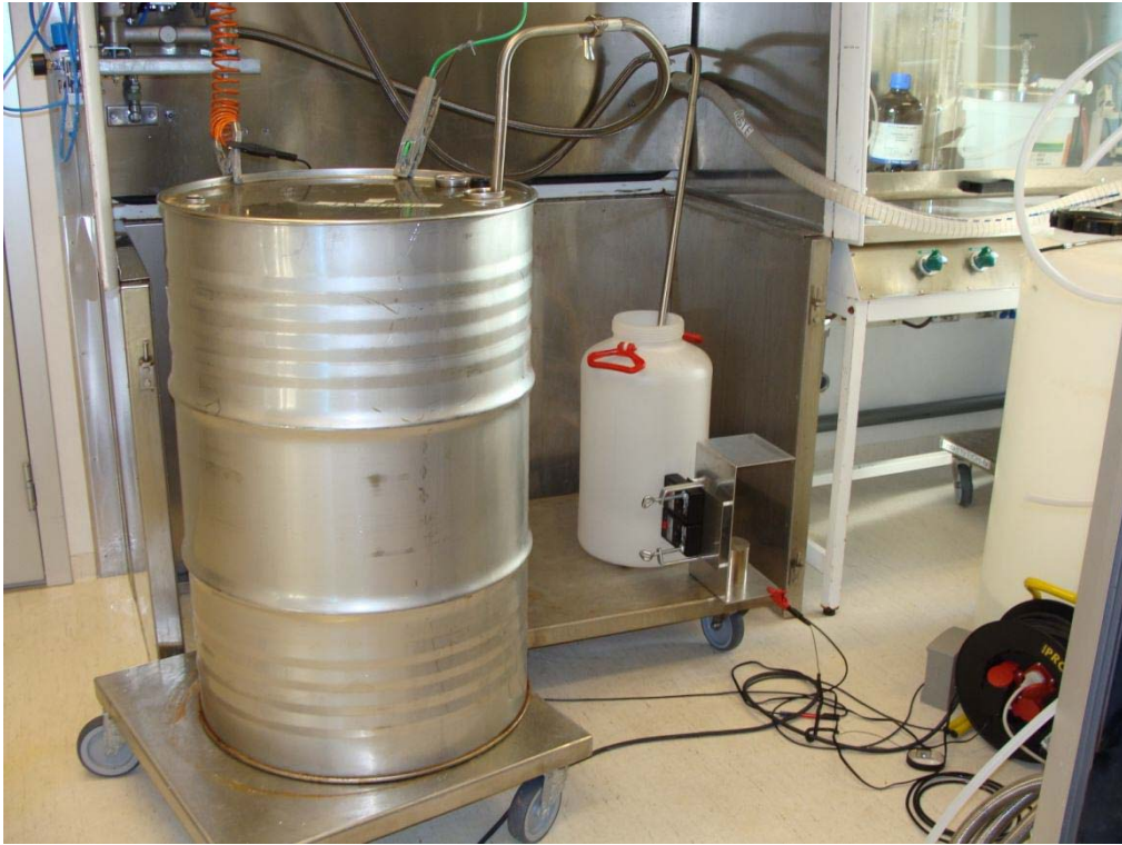
Bild 2, Fyllning med elektrisk pump från 200 l metallfat till 25 l plastkärl.
