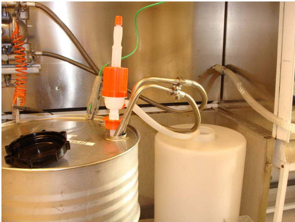
Bild 1, Fyllning med handpump av plast från 200 l metallfat till 120 l plastkärll
