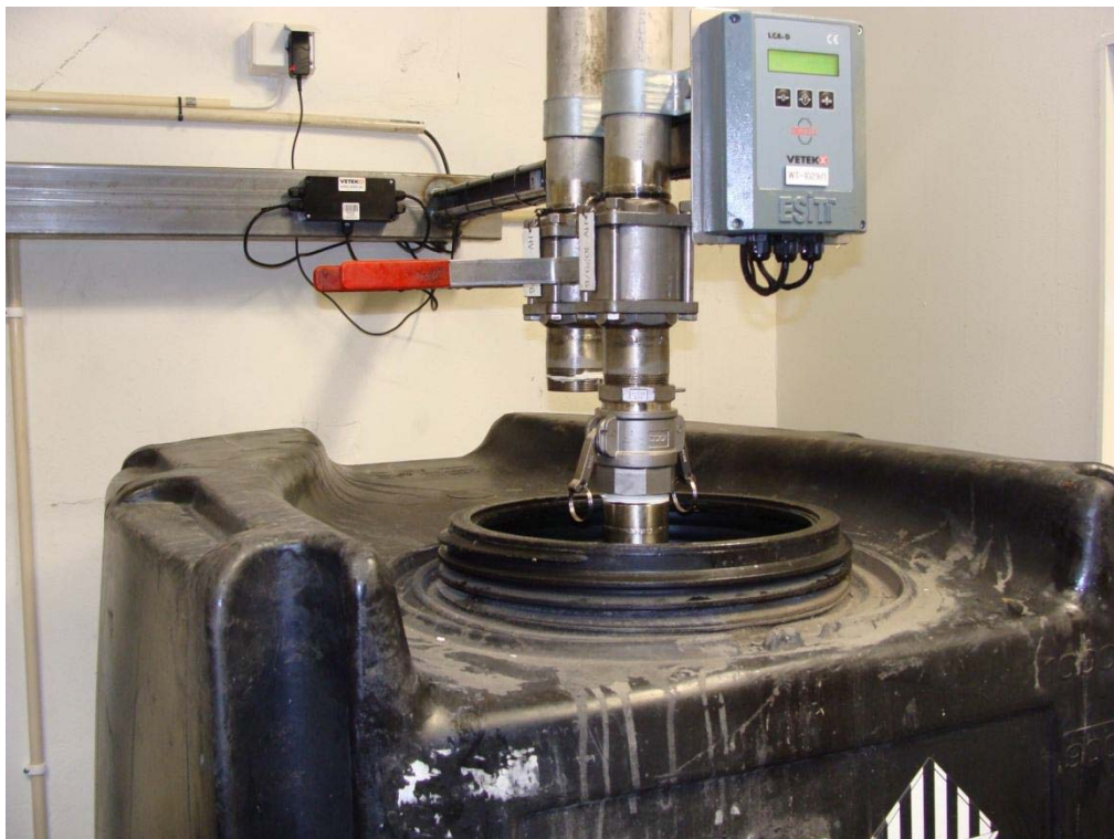
Bild 6 Fyllning med tapprör som går ända ner till botten av kärlet.
