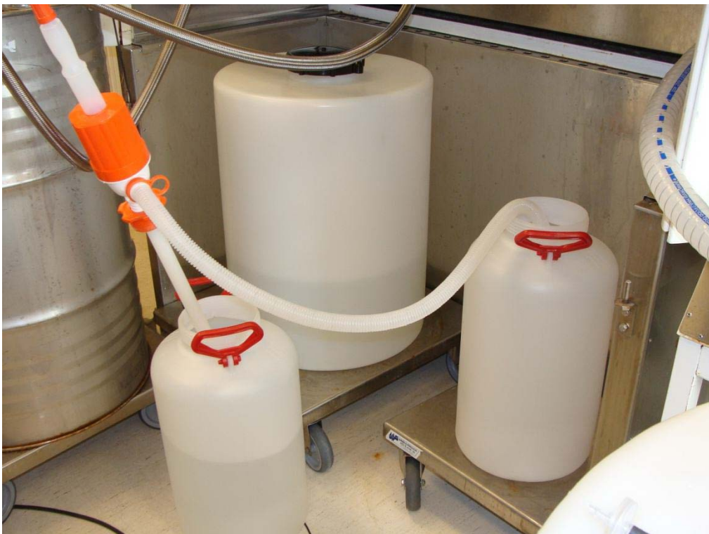
Bild 3, Fyllning med handpump av plast från 25 l plastkärl till 25 l plastkärl.
