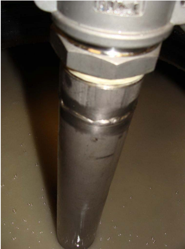
Bild 9, Fyllning med tapprör som går ca 50 cm ner i kärlet.
