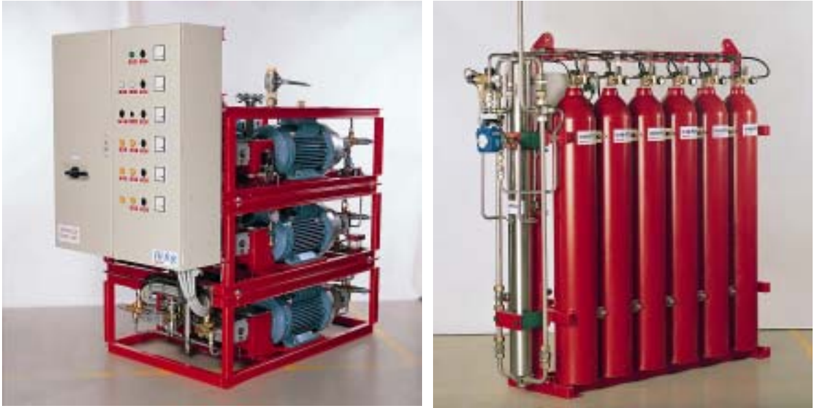
Figur 7 Två olika typer av vattenförsörjningar, till vänster en "traditionell" lösning där ett antal högtryckspumpar av displacementstyp drivs av var sin elmotor och till höger en "gasdriven" pump.
