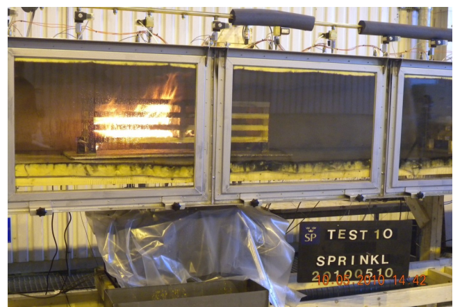
Bild 2 När systemet aktiverades, registrerades tiden och flödet samt temperaturer och luftflöden. Branden kontrollerades och förhindrades sprida vidare till nästa brandkälla.
