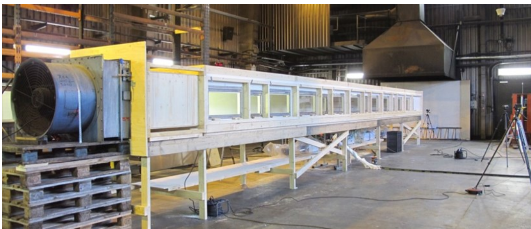
Figur 1. Försöksuppställning med den 1 m breda modell tunneln i skala 1:10.
