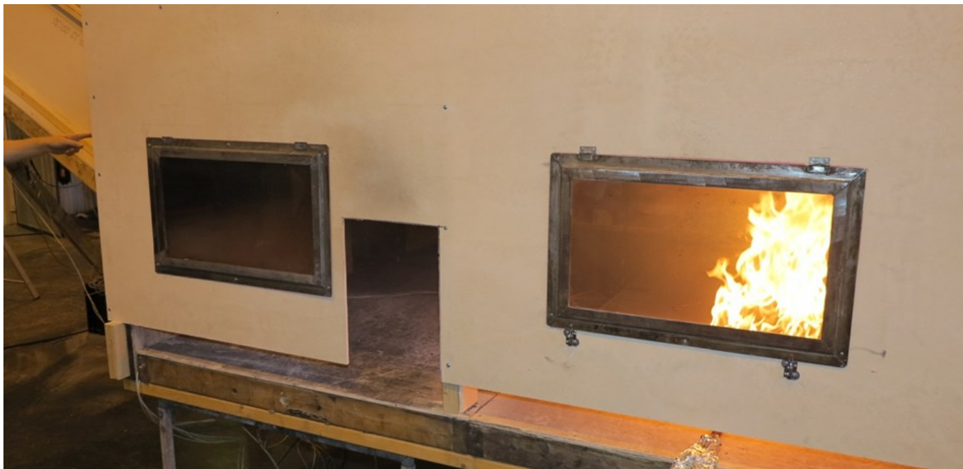
Figur 2. Värme genererades med gasolbrännare som gav upp till 50 kW, vilket motsvara 1.6 MW i fullskala. Denna brand genererade brandgastemperaturer över 75 °C
