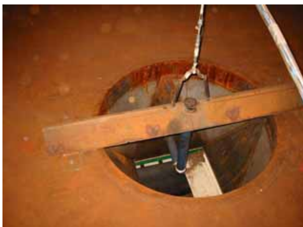
Figur 32 Foto av gasinloppet i silons centrum respektive motsvarande friliggande gasinlopp.
