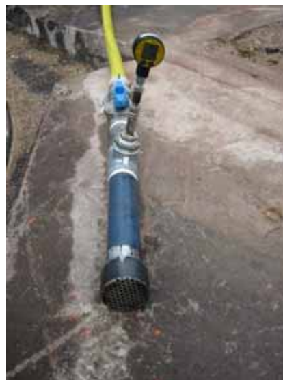
Figur 32 Foto av gasinloppet i silons centrum respektive motsvarande friliggande gasinlopp.
